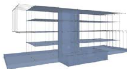
Modèle analytique structurel (ARCHICAD SAM)
